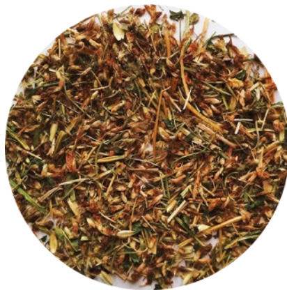
Рис. 2. Крупне сміття, сход з сита Фадєєва 2,0
