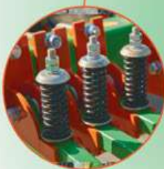
Регулювання прижиму секції від 0 до 450 кг
