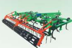
Культиватор суцільного обробітку КПА Ширина захвату від 4 до 8 метрів
