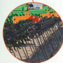
Зубо-пружинна гребінка - для досконалого «вичісування» ґрунтів
