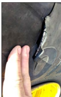
приклад бічного пошкодження
