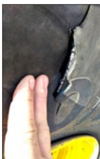
приклад бічного пошкодження
