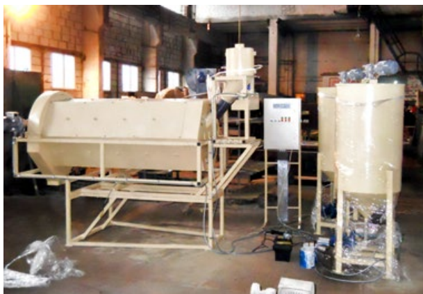
Рис. 6. Машина для передпосівної обробки насіння (ПСФ).
