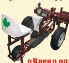
«Клен-1,8» з укладальниками крапельної трубки
