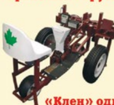
«Клен-1,8» з укладальниками крапельної трубки
