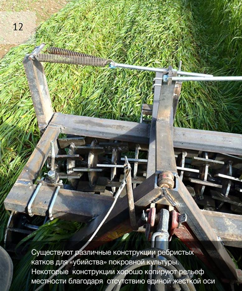
Существуют различные конструкции ребристых катков для «убийства» покровной культуры. Некоторые конструкции хорошо копируют рельеф местности благодаря отсутствию единой жесткой оси
