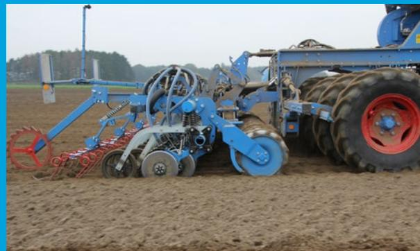
Сошникова балка з гідралічним притиском, шинний та важкий профільний коток
