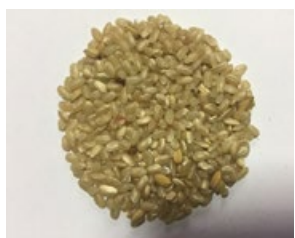
Рис. 7. Обрушенные зерна риса, прошедшие через решето Фадеева 2,2 (тяжелые семена после пневмовибростола)
