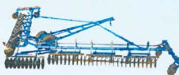
Лушильники дискові ЛДГ-5М, ЛДГ-10М, ЛДГ-15М
