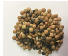
Рис. 5. Смесь камешков и чечевицы, сошедшая с «тяжелого берега» пневмовибростела
