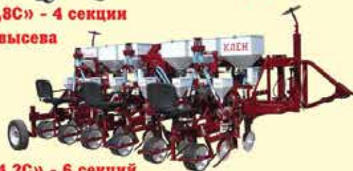
«Клен-4,2С» - 6 секций точного высева с внесением удобрений
