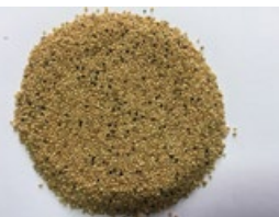
Рис. 5. Проход через сито Фадеева 1,5
