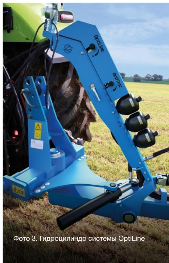
Фото 3. Гидроцилиндр системы OptiLine
