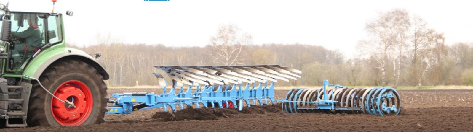
Фото 6. Diamant с однорядным катком Variopack, Диаметр 900 мм
