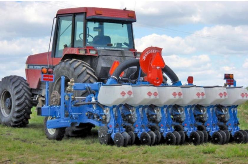
Сеялки точного высева «Моносем»
