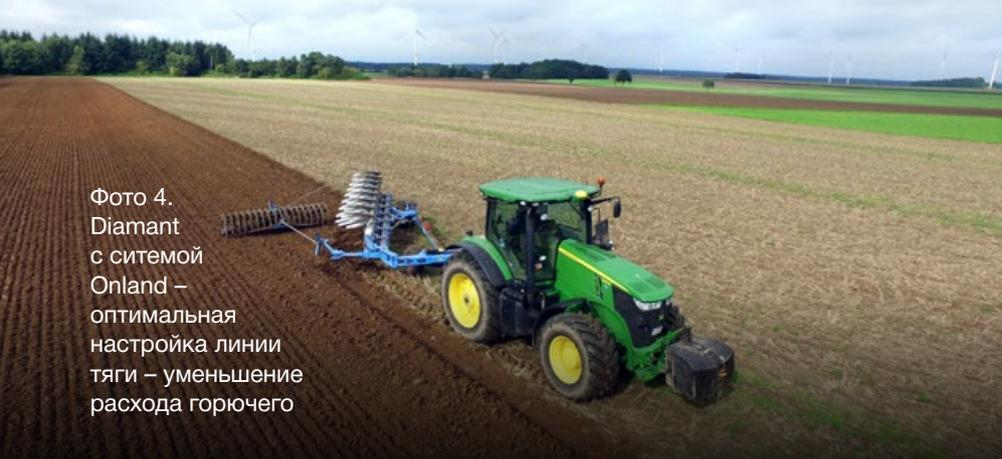
С НАЧАЛА 2019 ГОДА ПЛУГИ DIAMANT ОБОРУДУЮТСЯ НОВОЙ СИСТЕМОЙ ONLAND, КОТОРАЯ МОЖЕТ РАБОТАТЬ С ТРАКТОРАМИ ШИРИНОЙ БОЛЕЕ 4 м (фото 4).
