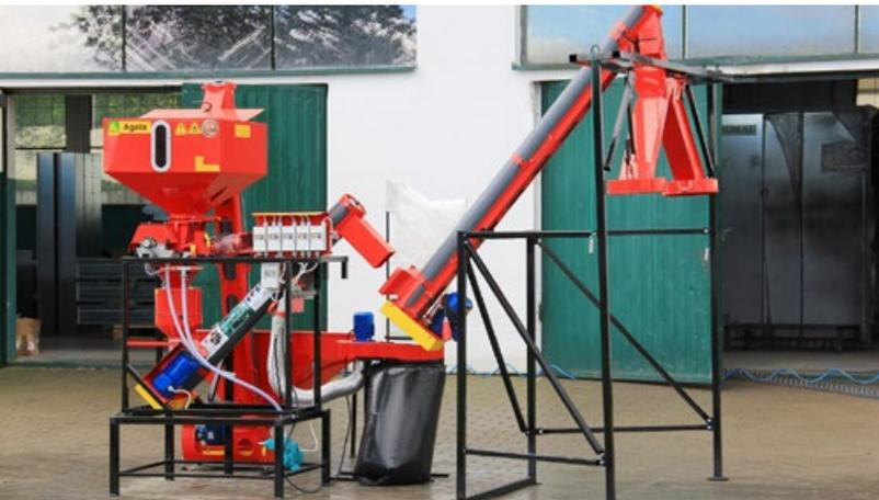
В современных протравочных машинах первичное распределение (распыление) рабочего раствора намного точнее, чем в технике «родом из 1980-х». Настройка более точная и более простая. Все необходимые измерительные инструменты (весы, датчики расхода рабочей жидкости и т.д.) интегрированы в сам агрегат.
