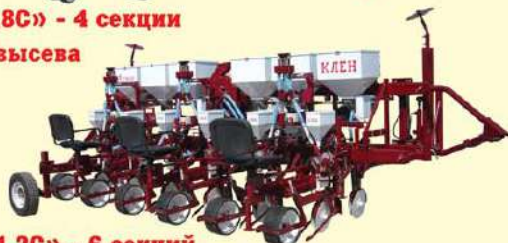
«Клен-4,2С» - 6 секций точного высева с внесением удобрений
