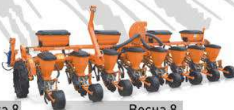
Весна 8 Універсальна пневматична сівалка точного висіву
