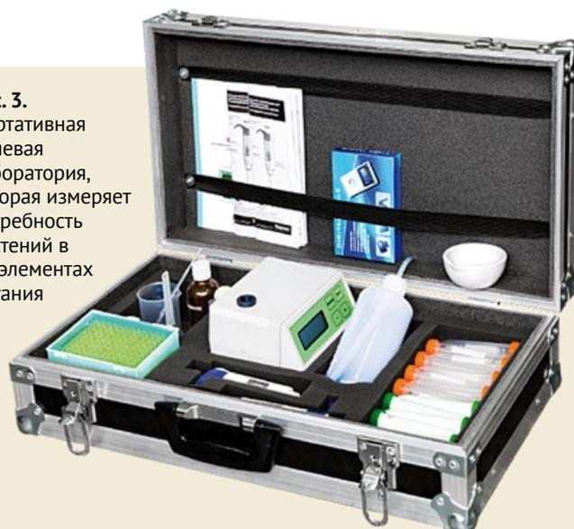
Рис. 3. Портативная полевая лаборатория, которая измеряет потребность растений в 14 элементах питания
