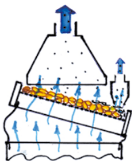
Рис. 5. Схема работы пневмовибростола (ПВСФ) высокой производительности
