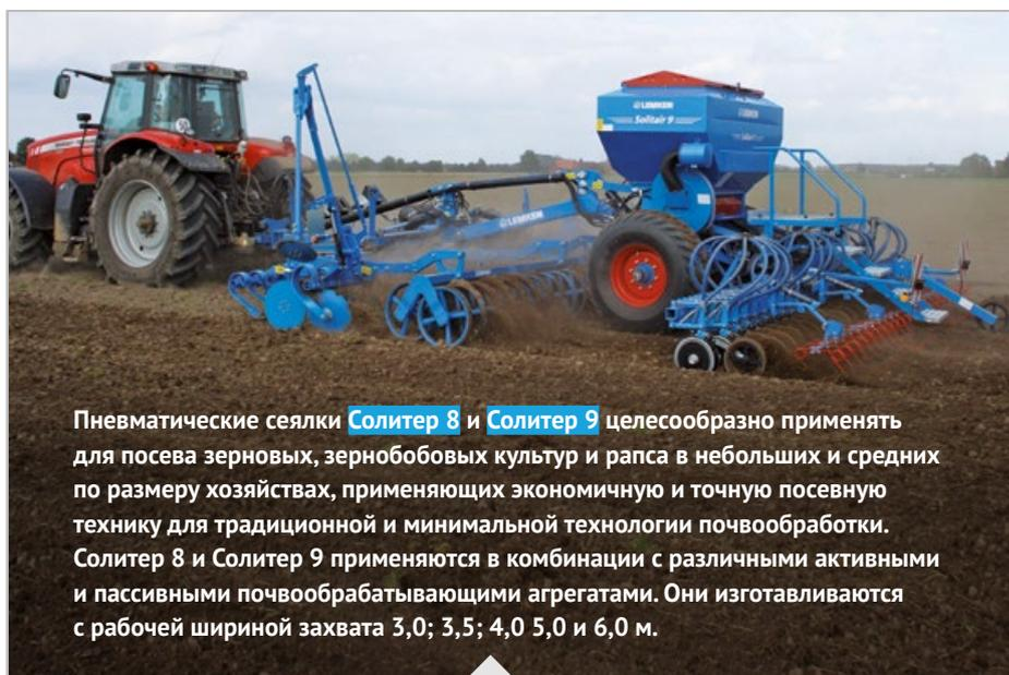
Пневматические сеялки **Солитер 8** и **Солитер 9** целесообразно применять для посева зерновых, зернобобовых культур и рапса в небольших и средних по размеру хозяйствах, применяющих экономичную и точную посевную технику для традиционной и минимальной технологии почвообработки. Солитер 8 и Солитер 9 применяются в комбинации с различными активными и пассивными почвообрабатывающими агрегатами. Они изготавливаются с рабочей шириной захвата 3,0; 3,5; 4,0 5,0 и 6,0 м.
