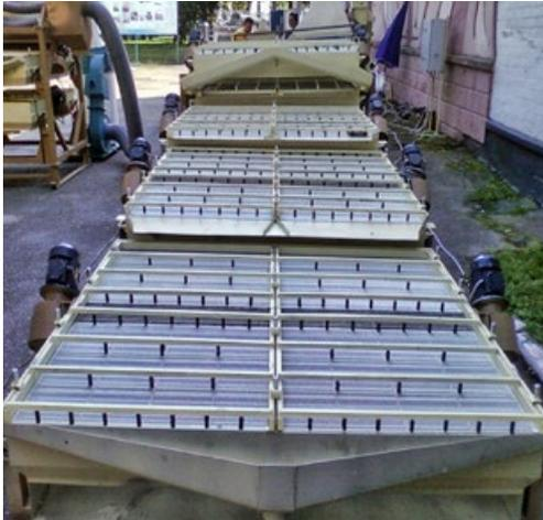
Рис. 6. Очищающе-калибрующая машина большой производительности
