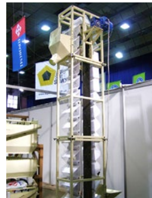
Рис.4. Нория поэтапной выгрузки (устанавливается в помещении)
