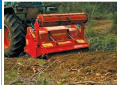
Рассмотрим данный процесс на основе универсальных лесных фрез **Multiforst/Starsoil** производства компании **Seppi M** (Италия). Конструкция машины представляет собой ротор с зафиксированными на его внешней
