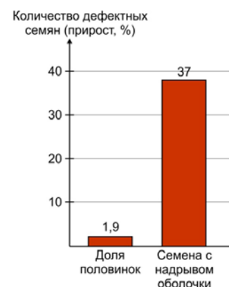
Рис. 3. Прирост травмированных семян сои при теплоносителе 45°C и влагосеме с 20% до 13%.
