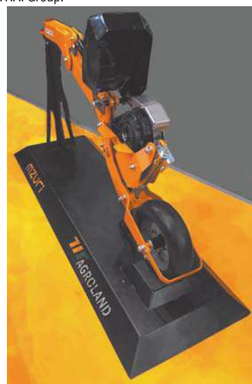
Сошник с адаптером точного посева для пропашных культур (кукуруза, подсолнечник)
