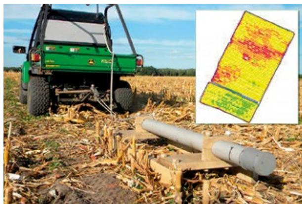
Рис. 3. Устройство для определения электропроводящих свойств почвы сенсорным методом.
