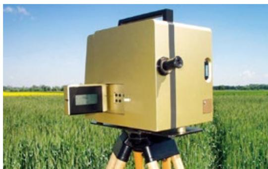
Рис. 9. Полевой спектрометр для тестирования состояния растительности.
