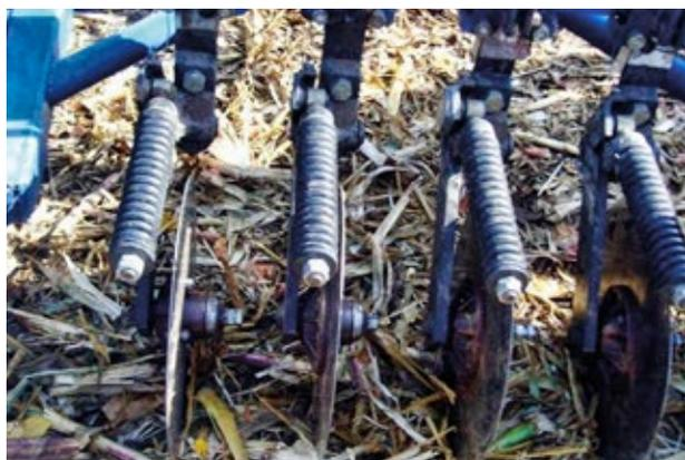
Рис. 2. Устройство для определения электропроводящих свойств почвы контактно-разрушающим методом.
