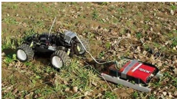
Рис. 4. Мобильное устройство для определения электропроводящих свойств почвы сенсорным методом.
