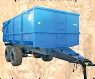
Напівпричіп тракторний НТС-10
