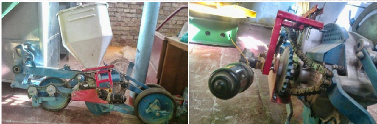
Фото 2. Общий вид усовершенствованной селки с пневматическим высевальным аппаратом
