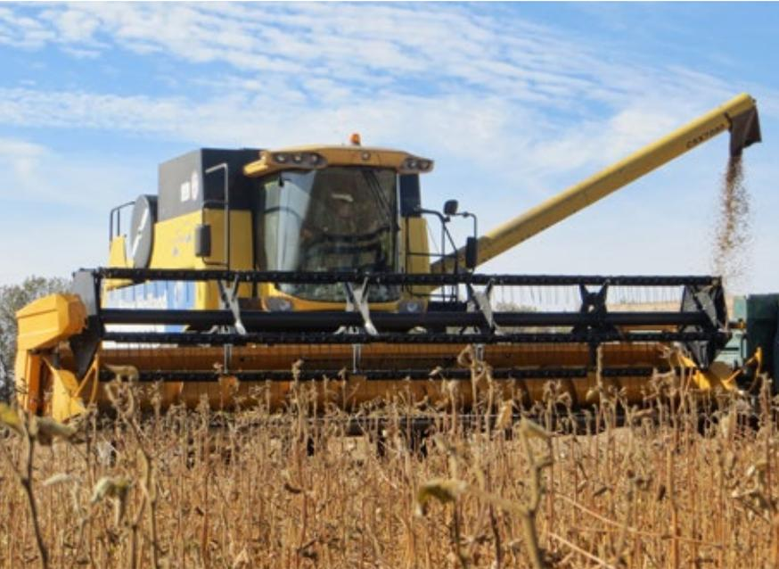
КОНСТРУКТОРЫ «БЕРДЯНСКИХ ЖАТОК» СПЕЦИАЛЬНО РАЗРАБОТАЛИ УНИВЕРСАЛЬНУЮ ЖАТКУ ДЛЯ УБОРКИ СОИ, КОТОРУЮ ТАКЖЕ МОЖНО ЗАДЕЙСТВОВАТЬ В УБОРКЕ ДРУГИХ КУЛЬТУР: ЗЕРНОВЫХ, ЗЕРНОБОБОВЫХ И КРУПЯНЫХ. А ЭТО ГОРАЗДО БЫСТРЕЕ ПРИВОДИТ К ЕЕ ОКУПАЕМОСТИ. ПО ПОДСЧЕТАМ КОНСТРУКТОРОВ, ОКУПАЕМОСТЬ ЖАТКИ ДЛЯ УБОРКИ СОИ ОТ ЗАВОДА «БЕРДЯНСКИЕ ЖАТКИ» СОСТАВЛЯЕТ 510 ГА.
