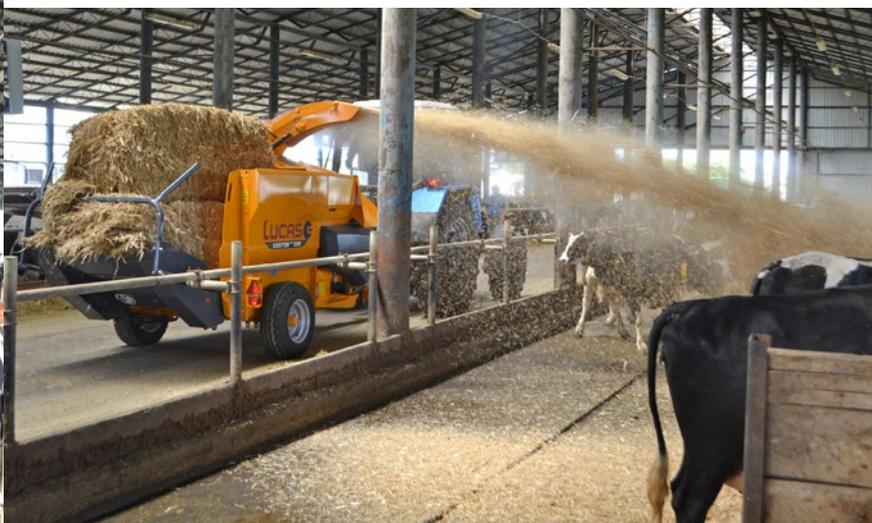
3. А вот выдув соломы при помощи турбины позволяет не только раздавать корма, но и эффективно делать подстилку из соломы. Узел раздачи и выдува соломы взят из линейки машин «Castor», которые уже доказали свою надежность и производительность.
