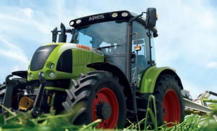
На тракторы «ARES 500» фирмы «CLAAS» устанавливаются силовые агрегаты с максимальной полезной мощностью от 96 л.с. (71 кВт) до 114 л.с. (84 кВт). Этот трактор полностью отвечает потребностям сельского хозяйства. В «ARES 500» применяются современные высокоэффективные и одновременно экономические четырехцилиндровые турбодизели объемом 4,5 литра с электронным управлением впрыскивания топлива.
