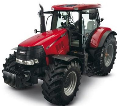
Эти машины, имея максимальную унификацию, представлены несколькими моделями. Они имеют общую конструкцию 6-цилиндрового двигателя с объемом цилиндров 6,7 л, но благодаря разным дополнительным элементам мощность тракторов находится в пределах от 125 до 210 л.с. Двигатели оборудованы электронной системой управления, которая регулирует максимальную мощность в зависимости от тягового сопротивления машины, поддерживая заданную скорость движения.
